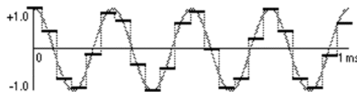
Une onde cosinusoidale de 4 000 Hz échantillonnée à 22 050 Hz
