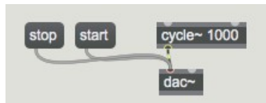
Certains objets MSP peuvent recevoir des signaux audio et des messages Max dans la même entrée.
